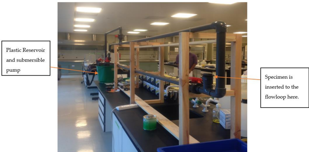
Figure 4. The actual flow loop.
